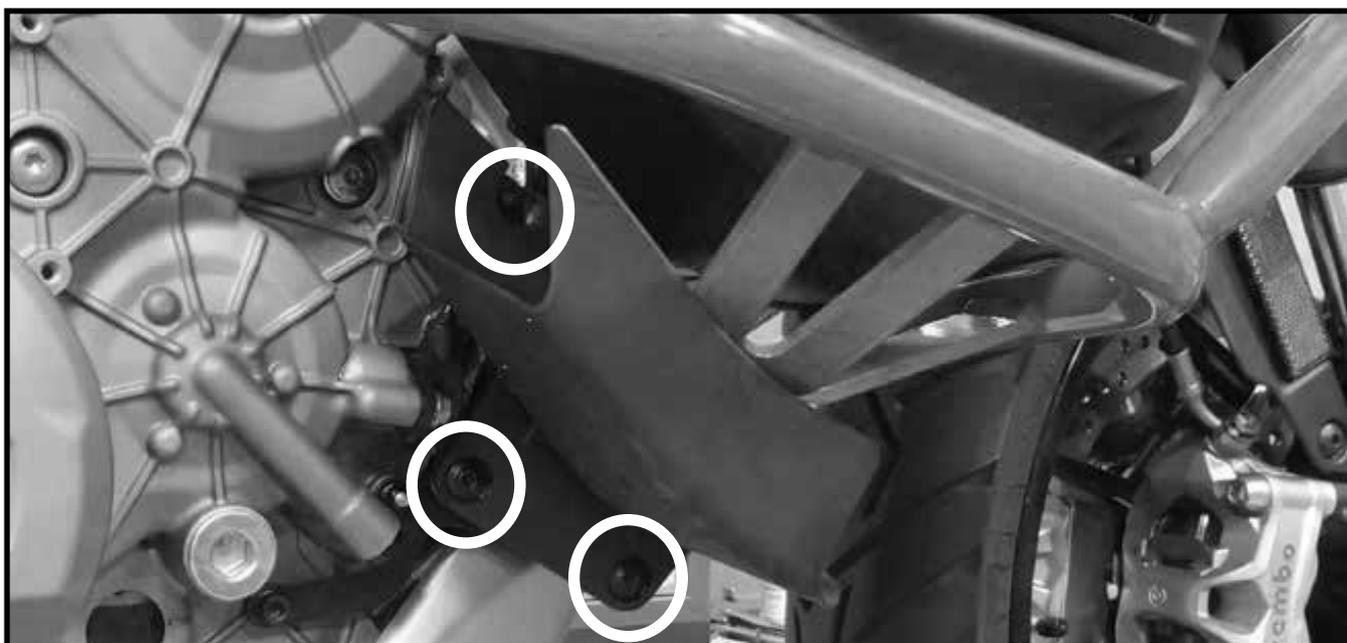
**Fissaggio della protezione destra, posteriore:**
