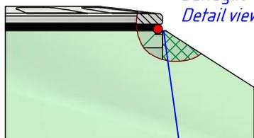
Dopo aver montato la flangia sul serbatoio inserire l'O-ring nella scanalatura che si forma tra la flangia e il serbatoio
