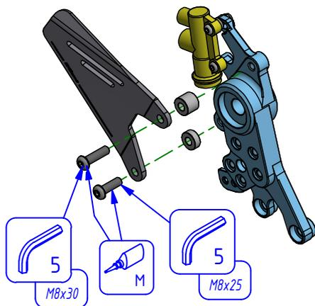
Montaggio con scarico OEM
