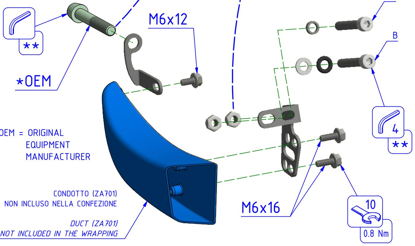
\*\* PER IL SERRAGGIO DELLE VITI RIFARSI AL MANUALE DEL COSTRUTTORE
