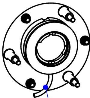
Adeguare la lunghezza del tubo di sfiato secondo necessità ed inserirlo nel foro previsto, presente nel serbatoio
